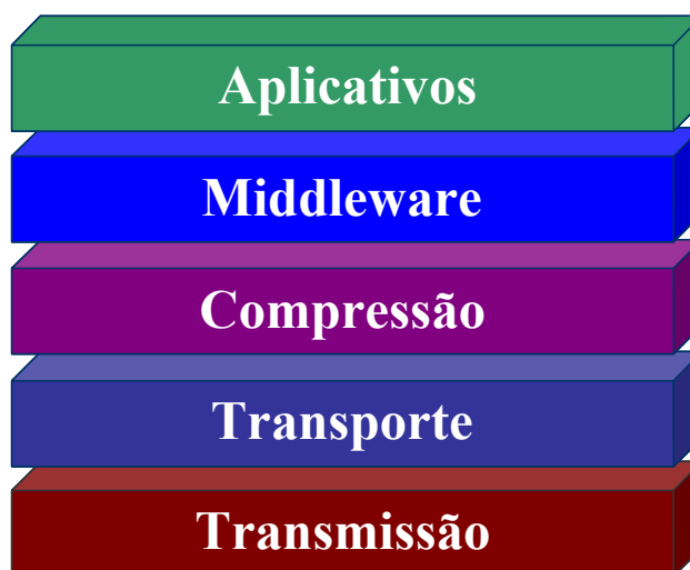
Figura 13. Camadas (ou subsistemas) de um sistema de TVD.
